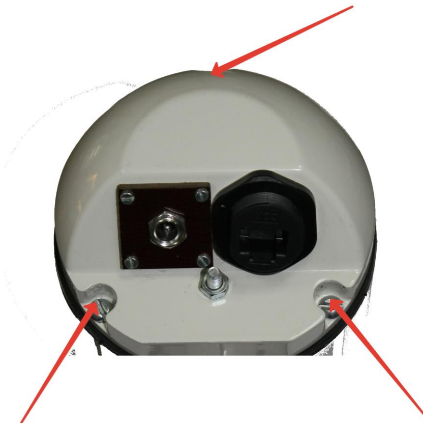
Рис. 14. – Винты крепления задней крышки камеры
