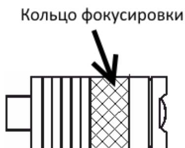
Рис. 8 - Изменение фокусировки пучка света
